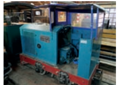
Lokdaten: Schöma D1, Baujahr ca. 1950, 10 PS Deutz-Motor.
