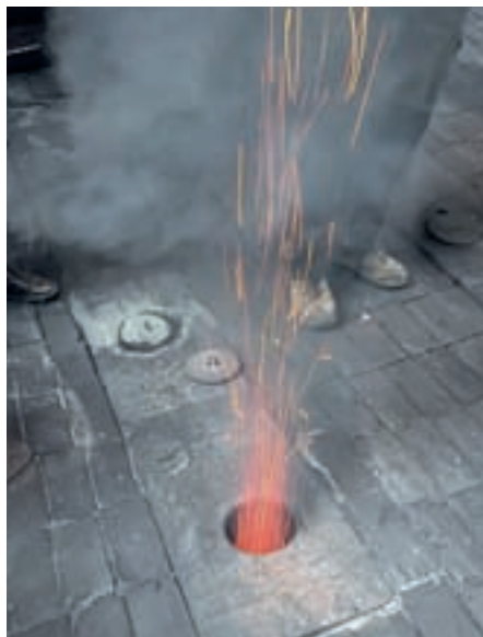
Entzündeter Kohlenstaub steigt wie bei einem Minivulkan aus dem Schürloch. Foto: Reinhold Berling.
